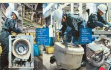
ドラム式洗濯機を手作業で分解！ひとつひとつ再生可能なプラスチックを取り出す。
